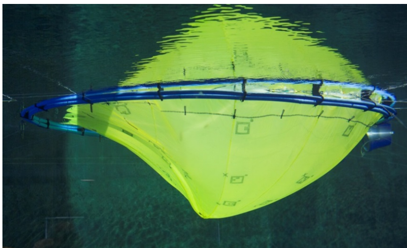
Figur 13. Kinahattduken går ned i bakkant (høyre i bildet). Bildet er tatt ved en strømhastighet på 61,8 cm/s
