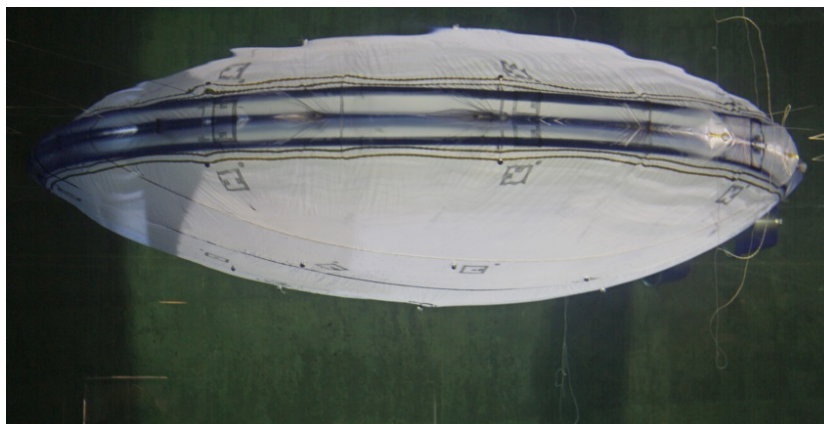
Figur 11. Muffinduk satt under normale forhold, og ytterligere optimalisert volummessig ved at reduksjonsbeltet ble løftet opp.
