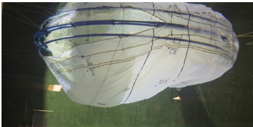
Figur 10. Eksempel på muffinduken under utsett. Merkene på duken er målepunkter benyttet for billedbehandling og databehandling i etterkant for å beregne volumet i duken matematisk.
